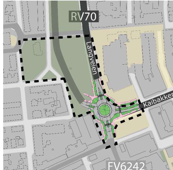
Figur 57 Situasjonsplan for påhuggsområde ved Kongens plass i forhold til byens veisystem. Innfartsårer (sort), sentrale gateforbindelser (grå) og øvrige by- og boligater (lys grå)
